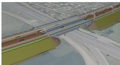
BIM-Modellausschnitt (Building Information Modeling) aus der Entwurfsplanung der beiden neuen Brücken über die Bundesstraße B 28 (August 2025) [Quelle: DB InfraGO AG]
