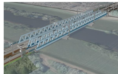
BIM-Modellausschnitt (Building Information Modeling) aus der Entwurfsplanung der beiden neuen Brücken über die Kinzig (August 2025) [Quelle: DB InfraGO AG]
