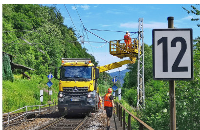
Blick auf ein Zweigegefahrzeug. Diese können wahlweise auf der Straße oder auf den Gleisen fahren (Juni 2022) [Quelle: DB Netz AG]
