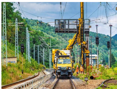
Blick auf ein Zweigegefahrzeug. Diese können wahlweise auf der Straße oder auf den Gleisen fahren (August 2022) [Quelle: DB Netz AG/Jörn Daberkow]
