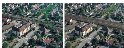
links: Heutige Situation im Bereich Heldelinger Straße in Weil am Rhein, rechts: Visualisierung der neuen Eisenbahnüberführung über die Heldelinger Straße mit Schallschutzwänden [Quelle: Deutsche Bahn AG]
