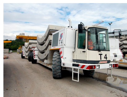
Transport der „Tübbinge“ – die Innenschalen der Röhren für den Katzenbergtunnel [Quelle: Deutsche Bahn AG]
