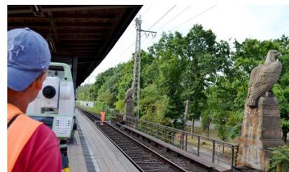
Im August 2022 fanden an der Eisenbahnüberführung „Bismarckstraße“ Vermessungen statt, um die Streckenpläne zu digitalisieren und zu aktualisieren. Die Messungen wurden mithilfe eines Tachymeters durchgeführt. Dieses dient der schnellen Auf- und Einmessungen von bestimmten Punkten. Die Ergebnisse der Vermessung fließen in die digitale 3D-Planung (Building Information Modeling) für die Brücken ein (August 2022) [Quelle: DB Netz AG/Carolin Grabbe]
