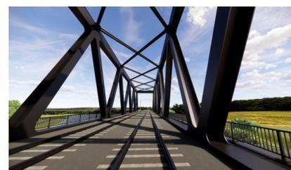
Visualisierung: Das Fachwerk der neuen Eisenbahnüberführung als Stahlbau (Mai 2022) [Quelle: DB Netz AG]
