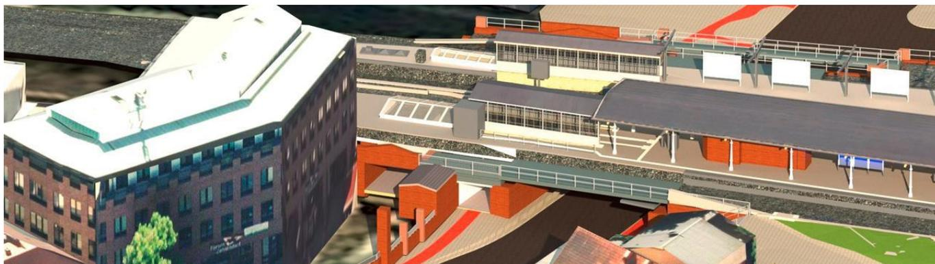
Visualisierung: Ein Bestandsmodell in 3D dient als Planungsgrundlage für den Bau eines weiteren Zugangs zum S-Bahnhof Berlin-Zehlendorf mit Aufweitung der Eisenbahnüberführung (EÜ) „Teltower Damm“ [Quelle: DB Netz AG]
