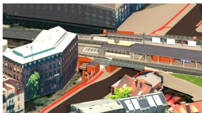
Visualisierung: Ein Bestandsmodell in 3D dient als Planungsgrundlage für den Bau eines weiteren Zugangs zum S-Bahnhof Berlin-Zehlendorf mit Aufweitung der Eisenbahnüberführung (EÜ) „Teltower Damm“ [Quelle: DB Netz AG]
