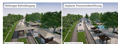
Visualisierung: Der bestehende Bahnübergang am Haltepunkt Hamburg-Sülldorf (links) wird durch eine Personenüberführung ersetzt (rechts) (August 2024) [Quelle: LoCLab Consulting GmbH]
