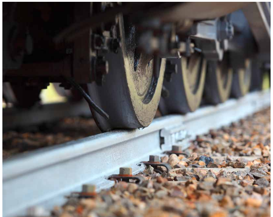
Züge sind durch die Gleise spurgeführt und können nicht unkontrolliert die Richtung wechseln.
