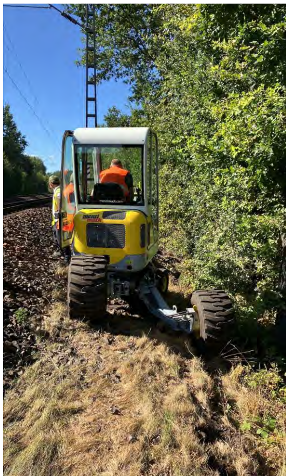
Flexibles Arbeiten im Böschungsbereich durch Schreitbagger
