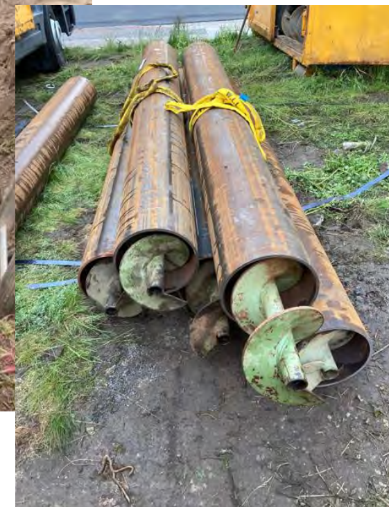
Herstellung von Gleisquerungen in geschlossener Bauweise
