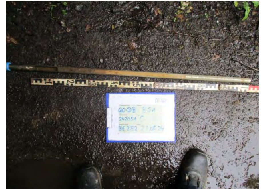
Foto 6: Bohrkern der Bohrsondierung BS1
