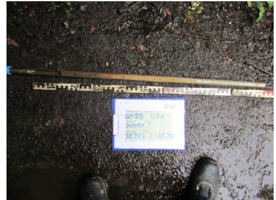
Foto 6: Bohrkern der Bohrsondierung BS1
