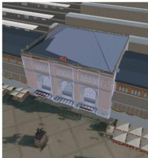
Nach einem Augenblick sehen Sie, wie der Teil des 3D-Modells, der sich in dem Volumen befand, blau angelegt wird. Das ist der Teil, der gemessen wurde. Der zu messende Teil wird aus dem 3D-Modell herausgeschnitten und farblich markiert, so dass Sie sehen können, welchen Bereich Sie genau gemessen haben. Im PopUp-Menü wird das Volumen als Kubikmeterzahl angezeigt. Durch Drücken der Taste „Schließen“ im PopUp-Menü beenden Sie den Messvorgang.
